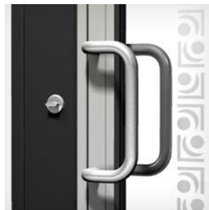
Lås i karm. Eliminerar klämrisk vid vred. Enklare kabeldragning vid elmotorlås.
